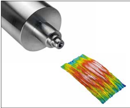
Acier Mesure des vibrations d'usinage sur un rouleau d'impression (DHM S2)
