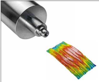
Stahl Oberflächen-Rotationsmessung (Drall) einer Druckwalze (DHM S2)
