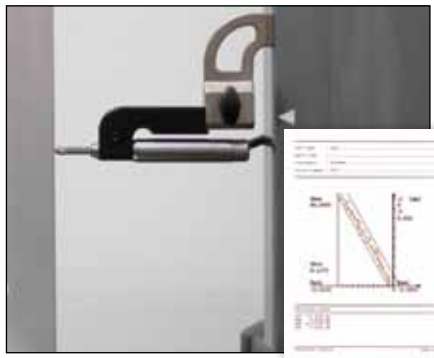
Rechtwinkligkeitsprüfung mit zusätzlichem elektronischen Messtaster und Farbausdruck (TA-MS-101)
