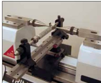
Kalibrieren von Gewinde- Lehrdornen (HPA-1/TEL6/3P/ 0.17-3.2/S6.5/LABC-15)
