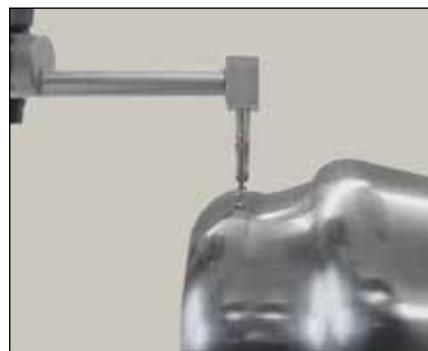
Prüfen der Oberflächengüte eines polierten Teiles (TA-MS-607)
