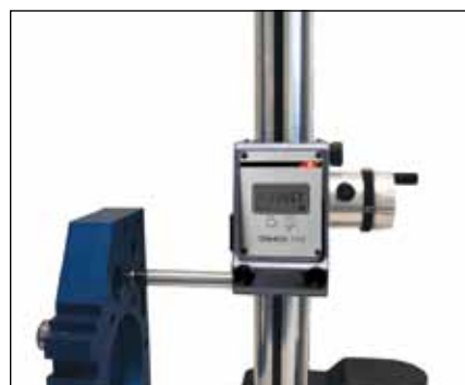
Mesure d'entraxes avec cônes (TVM5)
