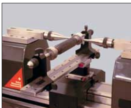
Contrôle de tampons filetés (HPA-1/TEL6/3P/0.17-3.2/S6.5/LABC-15)
