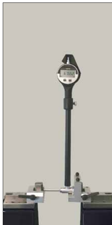
Etalonnage de vérificateurs d'alésages à 2 points (TEL5/TA-SU-301)
