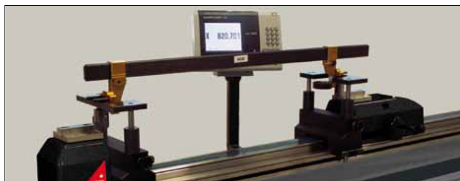
Etalonnage d'une jauge de grande dimension (TEL5)
