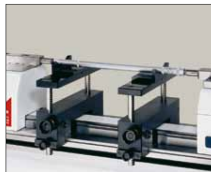
Etalonnage de micromètres d'intérieur à 2 points (HPA-1/TELMA7/TELMN7.2)
