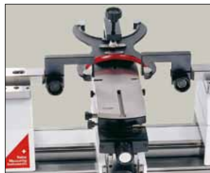
Vérification de calibres-mâchoires (TA-SU-313/TEL14N)
