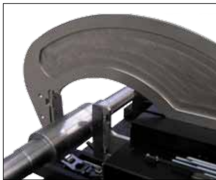
Installation pour la mesure de diamètre excentrés (construction spécifique)
