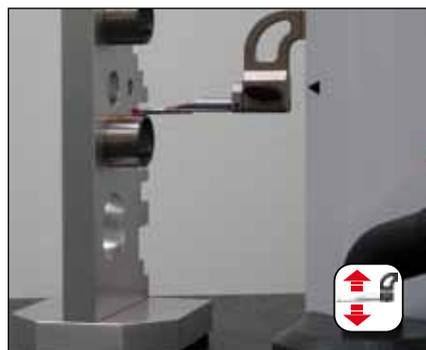
Автоматическое измерение внешних диаметров с помощью системы «TRIMOS® NC movement»
