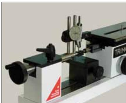
Калибровка рычажных индикаторов (THV-100/THV-150)
