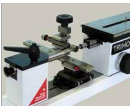
Калибровка гладких и резьбовых калибр-пробок с использованием стола THV-115
