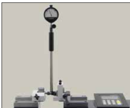
Étalonnage de vérificateurs d'alésages à 2 points (TEL5/TA-SU-301)
