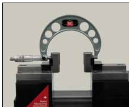
Vérification de micromètres extérieurs (TEL5/TEL11)
