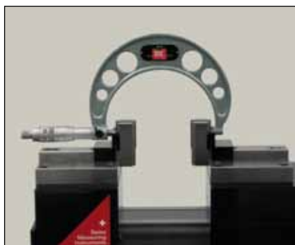
Prüfen von Bügelmessschrauben (TEL5/TEL11)
