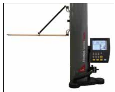
Standard-Messeinsätze bis 320 mm (hier Sonderausführung 550 mm)
