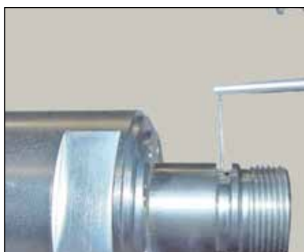
Prüfen der Oberflächenrauheit einer Aussparung (TA-MS-609)
