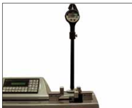
Einstellen eines 2-Punkt-Bohrungsmessgerätes mit Digital-Messuhr.
