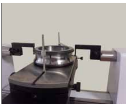
Automatische Aussenmessung eines Kugellager-Rings
