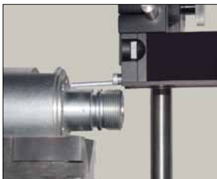
Prüfen von Oberflächenrauheit nahe einem Absatz (TA-MS-601)
