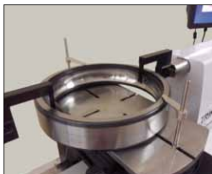
Automatische Innenmessung eines Kugellager-Rings
