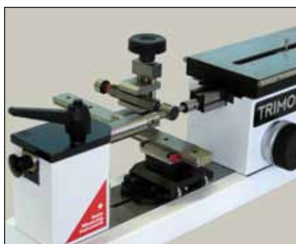
Kalibrieren von Lehdornen und Gewindelehdornen mit schwimmendem Messtisch (THV-115)
