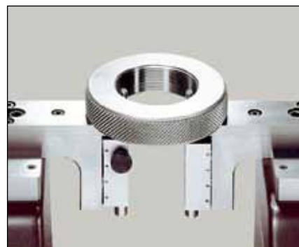
HPA: Prüfen von Gewinde-Lehringen (TEL18)
