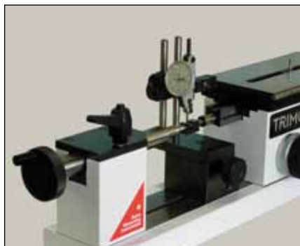
Prüfen von Fühlhebelmessgeräten (THV-100 / THV-150)
