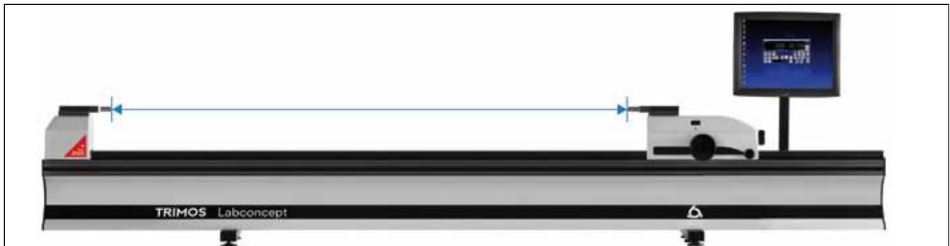
Direktmessung über den ganzen Messbereich.
