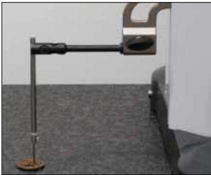
Höhenmessung einer Platine (TA-IH-109/V-50.5/TA-MI-118)
