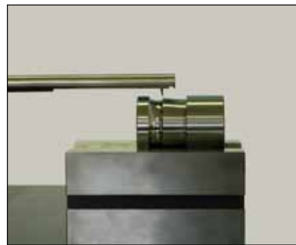
Konturenmessung mit TR Profile DH-8/VHF (TA-MS-650)
