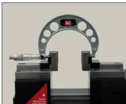
Prüfen von Bügelmessschrauben (TEL5/TEL11)
