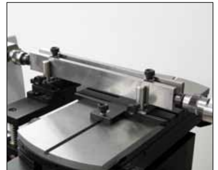
Vergleichsmessung von Endmassen > 250 mm (TA-SU-307/TEL7/TELMA7)
