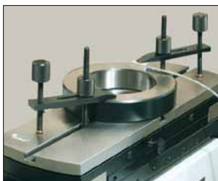
Temperatur kompensations-system TempComp
