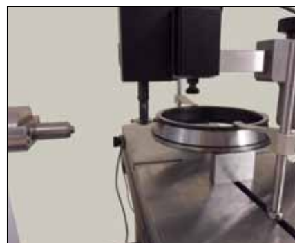
Automatische Aussenmessung eines kegeligen Rings
