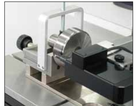
Prüfen von kegeligen Gewindelehrdornen (TA-MS-381/TEL75)
