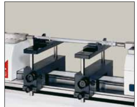
Kalibrieren von 2-Punkt-Messschrauben (HPA-1/TELMA7/TELMN7.2)
