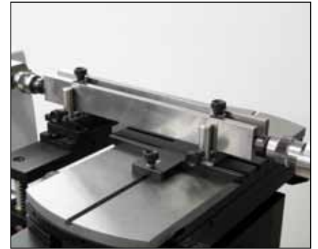
Vergleichsmessung von Endmassen > 250 mm (TA-SU-307/TEL7/TELMA7)
