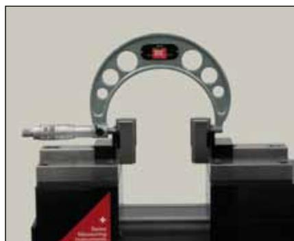
Vérification de micromètres extérieurs (TEL5/TEL11)
