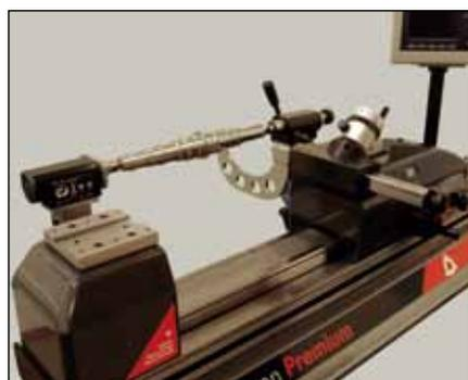
HPA: Mesure de pièces cylindriques (TA-MS-303)
