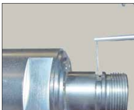
Prüfen der Oberflächenrauheit einer Aussparung (TA-MS-609)
