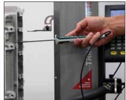
Messung mit Temperaturkompensation und einer optionalen externen Sonde (TA-EL-120)
