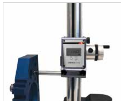
Mesure d'entraxes avec cônes (TVM5)
