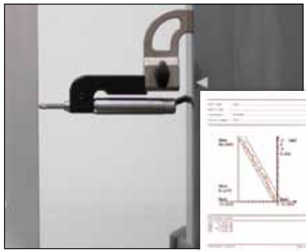
Mesure de perpendicularité avec palpeur électronique et impression couleur de la courbe (TA-MS-101)
