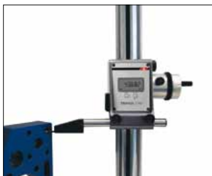
Mesure de diamètre avec touche bidirectionnelle (TVM4)
