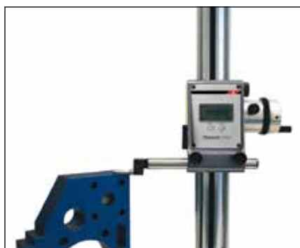
Mesure de hauteurs et de profondeurs (TVM1/1.1/2)
