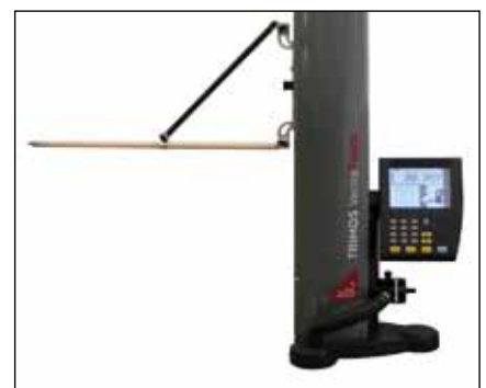
Touches standard jusqu'à 320 mm. (Ici en option 550 mm)
