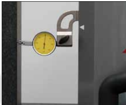
Perpendicularité ajustée mécaniquement sur tous les instruments
