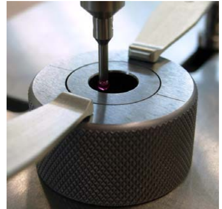
Figure 2 Etalonnage 100% automatique d'une bague de haute précision
