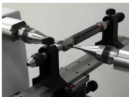
Contrôle d'un tampon lisse
