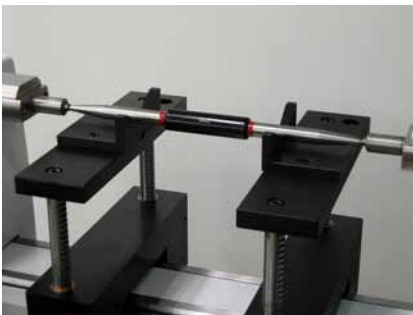
Contrôle d'une tige-étalon
