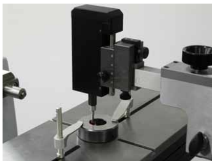
Étalonnage d'une petite bague lisse (dès Ø 2 mm en standard)
