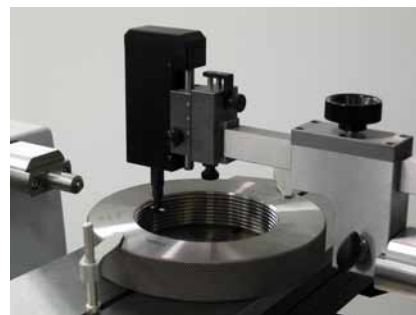
Contrôle d'une bague filetée (dès M3 en standard)
