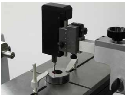
Prüfen von kleinen Lehr- ringen ab 2 mm Ø als Standard
