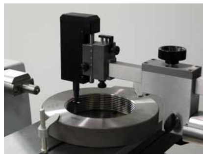
Prüfen von Gewindelehr- ringen ab M3 als Standard
