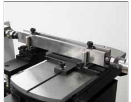
Vergleichsmessung von Endmassen
