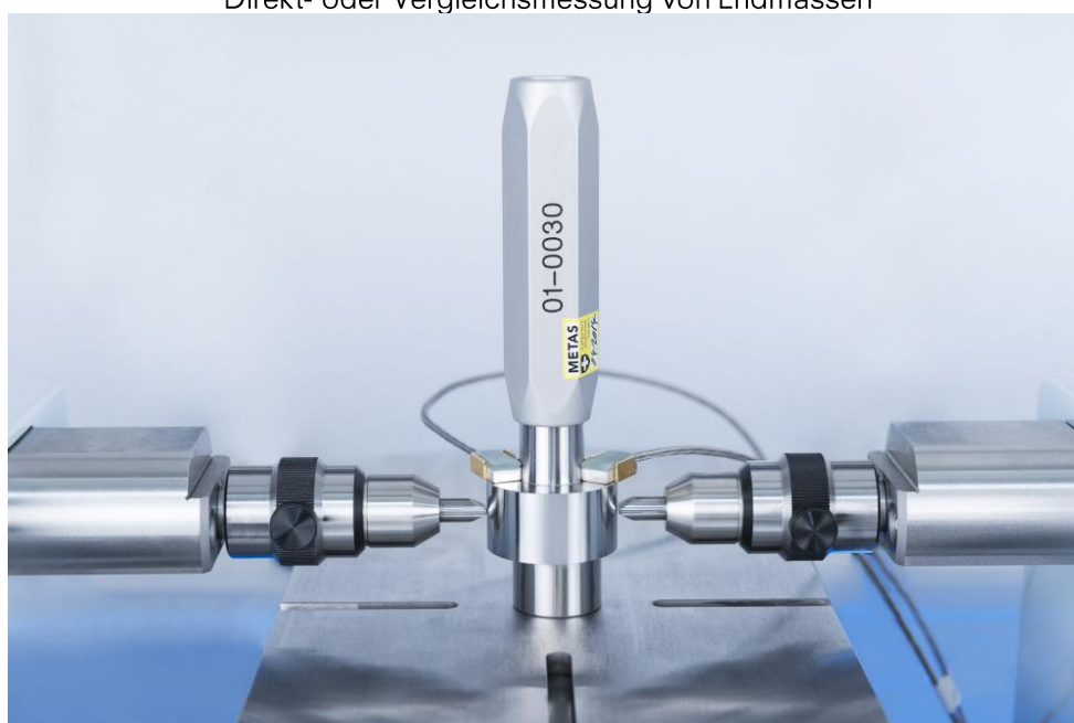
Direkt- oder Vergleichsmessung von Lehrdornen
