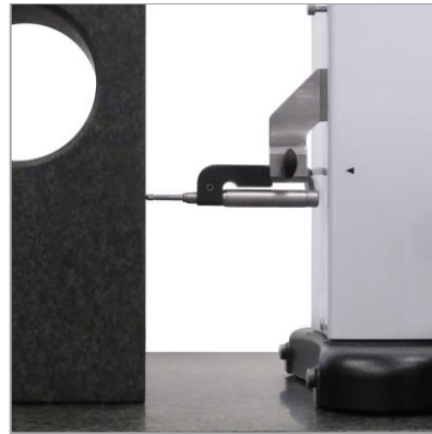
Mesure de perpendicularité avec palpeur électronique
