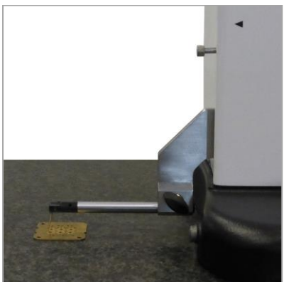
Mesure de hauteur sur platine de montre
