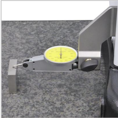
Feinverstellung: Genau Positionierung des Messschlittens für Applikationen mit Fühlhebelmessuhr
