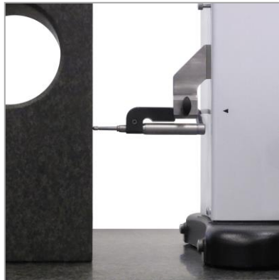
Mesure de perpendicularité avec palpeur électronique
