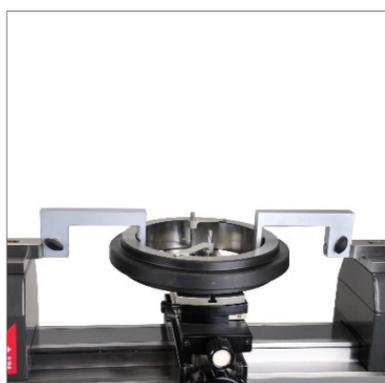
Contrôle d'une bague lisse
