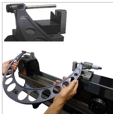
Contrôle manuel de grands micromètres (TEL5)(TEL11)
