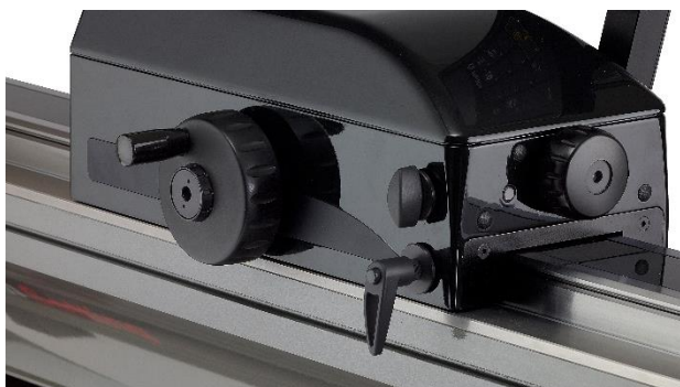
Blocage du chariot et blocage du réglage fin
