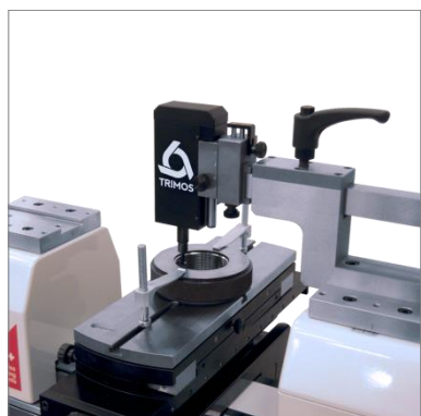
Etalonnage de bagues filetées (TA-SU-313, TA-MS-370, TA- SU-354, TUML13.2, TA-MS- 307)
