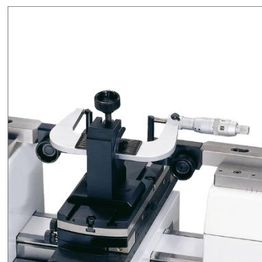
Etalonnage de micromètres extérieurs (TA-SU-313, HPA-1, TULM14)
