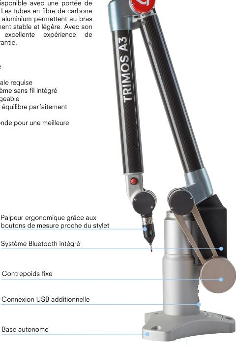
Palpeur ergonomique grâce aux boutons de mesure proche du stylet
