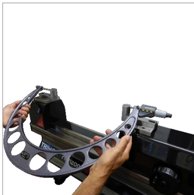
Manuelles Prüfen großer Bügelmessschrauben (TEL5, TEL11)
