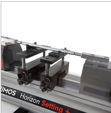
Prüfen und Einstellen von 2-Punkt-Innen-Vergleichsmessgeräten (TELMA7)
