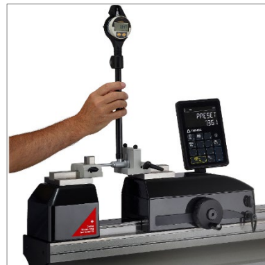
Manuelles Einstellen von 2-Punkt-Bohrungsmessgeräten (TA-SU-301, TEL5)
