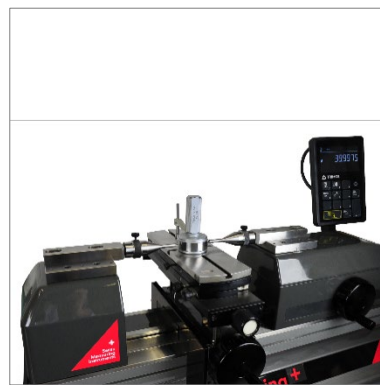
Prüfen von Lehdornen ( grosser als 100mm Durchmesser) (TEL6, TA-SU-313, TULM6/L0.5, TA-SU-304)
