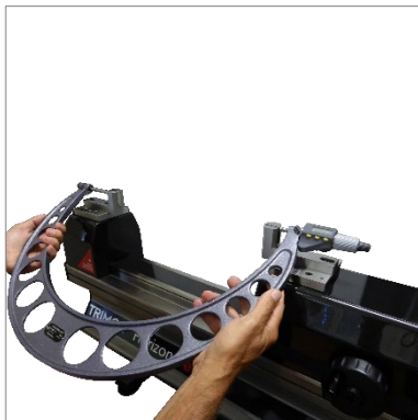
Contrôle manuel de grands micromètres (TEL5, TEL11)
