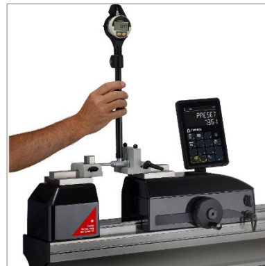
Etalonnage manuel de vérificateurs d'alésages à 2 points (TA-SU-301, TEL5)
