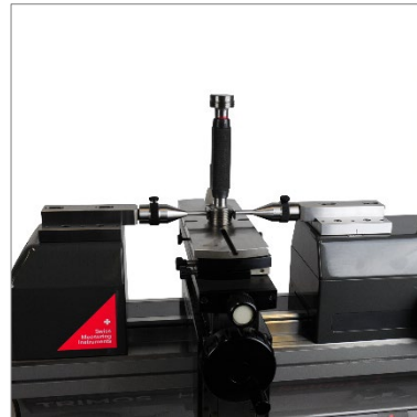
Contrôle de tampons filetés (de M30 à M250) (TA-SU-313, TEL6, 3P/0.17-3.2/S6.5)
