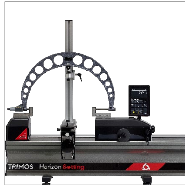
Contrôle de grands micromètres avec support (TA-SU-313, TA-SU-309, TEL5)
